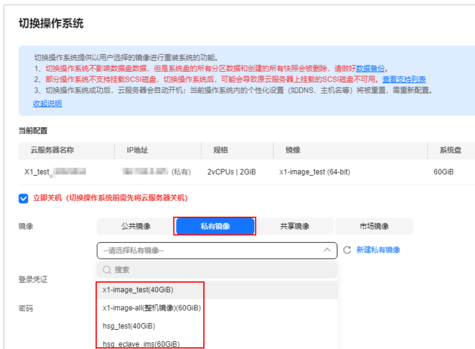
图 4-2 Flexus X 实例切换私有镜像
