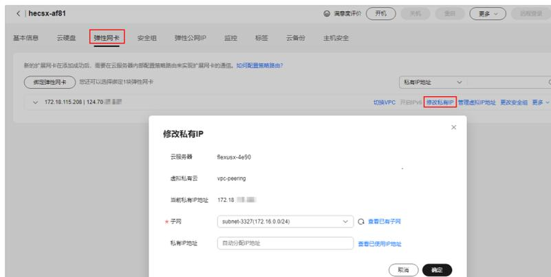
4. 请根据需要修改主弹性网卡的“子网”、“私有IP地址”后，单击“确定”。
