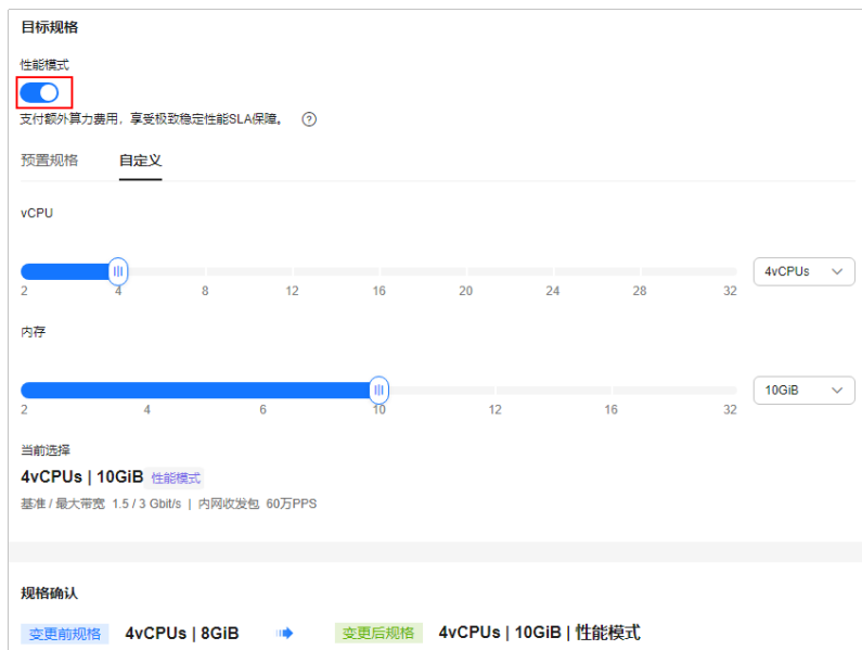
图 3-3 通过“变更规格”功能开启性能模式
