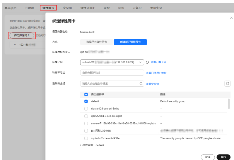
图 6-1 绑定弹性网卡
