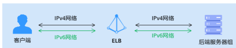
图 1-7 TCP 和 UDP 协议未开启 IPv4/IPv6 地址转换业务架构图
