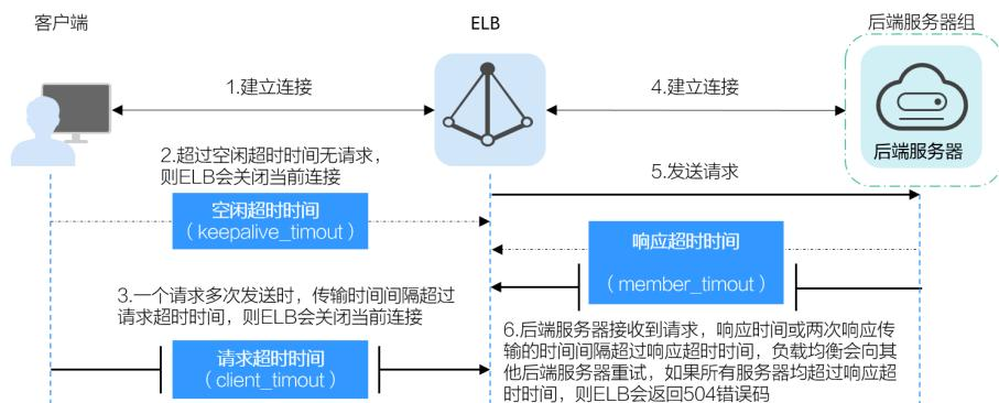
图 2-2 四层监听器超时时间示意图
