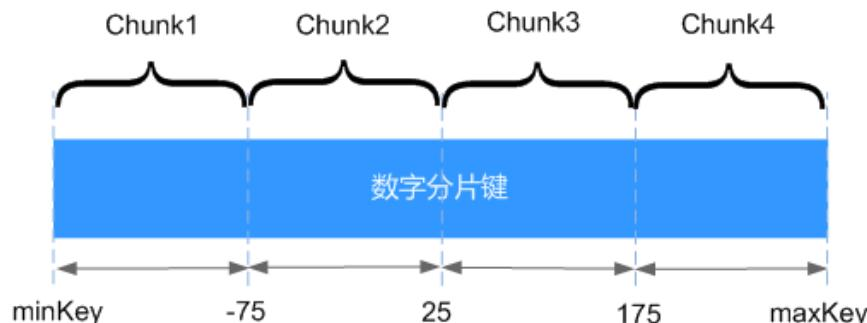
如上图所示， $x$ 表示范围分片的片键， $x$ 的取值范围为 $[minKey, maxKey]$ ，且为整型。将整个取值范围划分为多个chunk，每个chunk（通常配置为64MB）包含其中一小段的数据。其中，chunk1包含 $x$ 值在 $[minKey, -75]$ 中的所有文档，每个chunk的数据都存储在同一个分片上，每个分片可以存储多个chunk，并且chunk存储在分片中的数据会存储在config服务器中，dds mongos也会根据各分片上的chunk的数据自动执行负载均衡。
