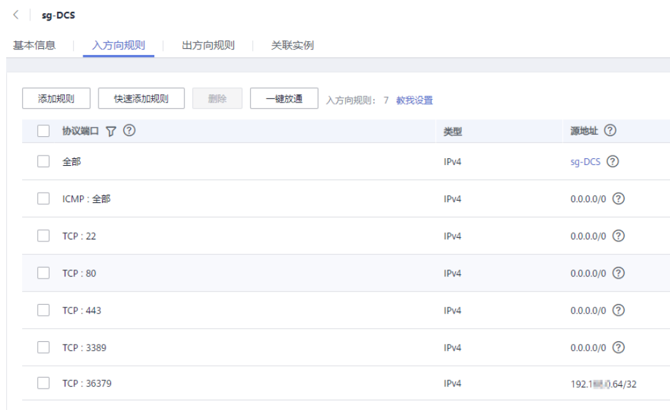
图 4-13 安全组规则（端口配置为 36379）
