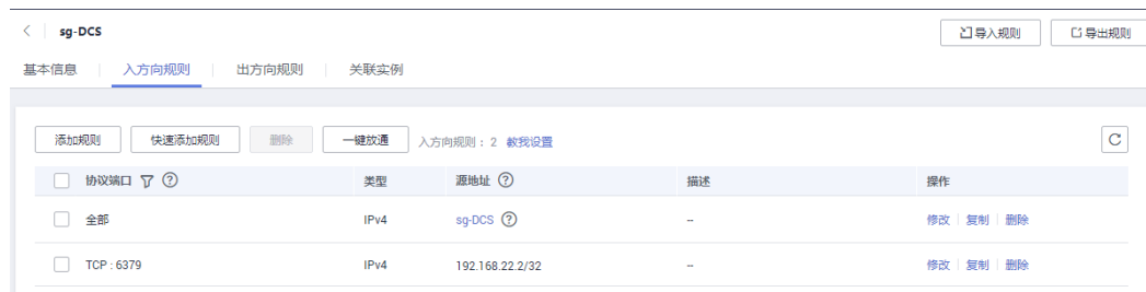
图 4-19 安全组规则（端口配置为 6379）
