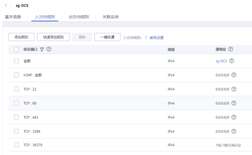
图 4-17 安全组规则（端口配置为 36379）
