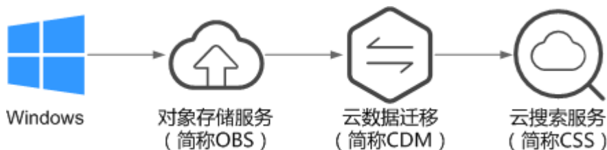
图 2-11 使用 CDM 从 OBS 导入数据到 Elasticsearch 时的数据传输流程
