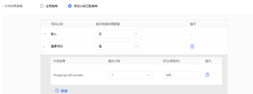
图 2-651 根据结果配置号码分类匹配策略
