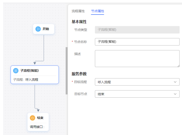
图 2-255 实际业务流程示例（子流程图元）
