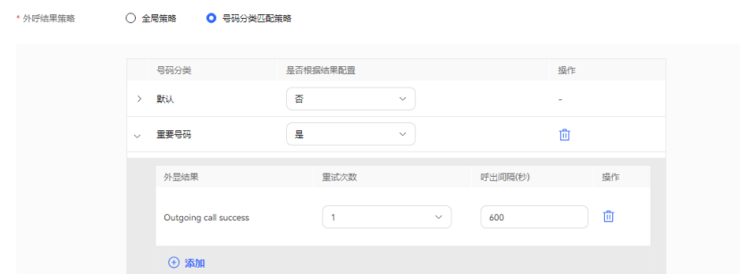
图 2-613 根据结果配置号码分类匹配策略
