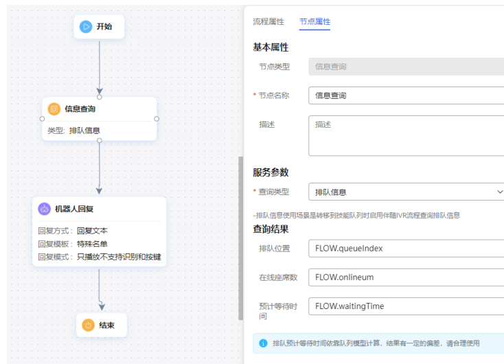
图 2-188 编排流程示例
