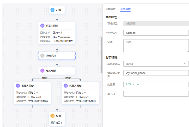
图 2-207 流程编排示例（按键识别图元）
