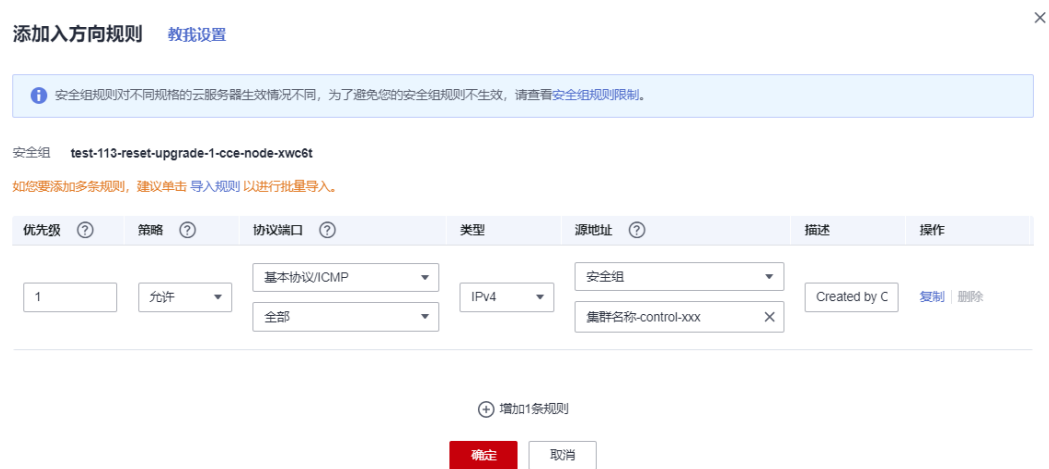
图 3-19 对 Master 安全组放通 ICMP 协议
