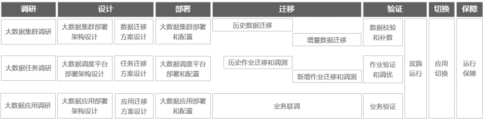
图 6-38 大数据迁移流程
