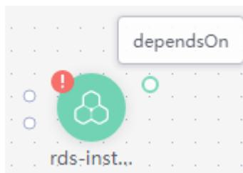
鼠标移动到左侧资源的绿色圈上，单击该绿色圈，会出现一个箭头，拖动鼠标，将箭头拖动到右侧资源上，放开鼠标。表示左侧的资源依赖于右侧资源。
