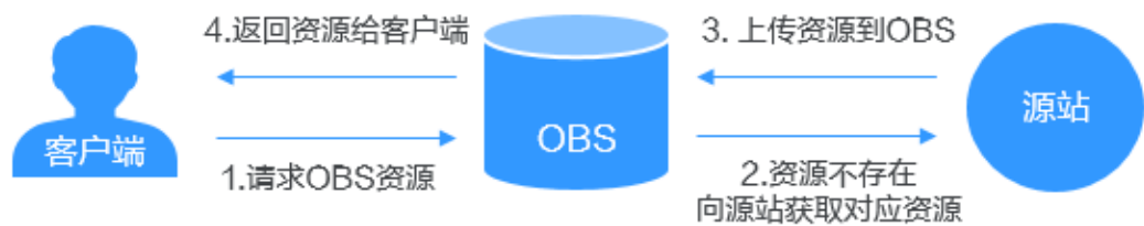
图 7-2 镜像回源流程
