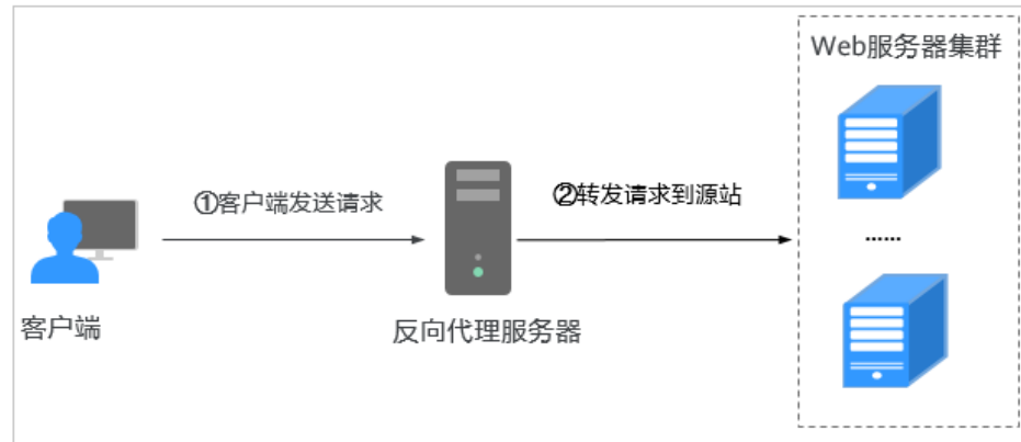
图 16-3 Nginx 转发原理
