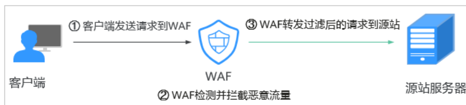
图 1-1 网站接入 WAF 防护原理
