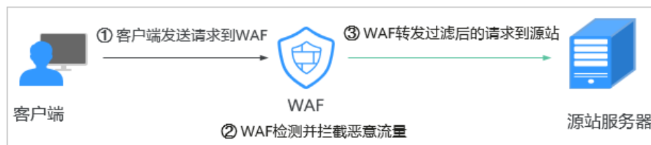
图 16-2 网站接入 WAF 防护原理
