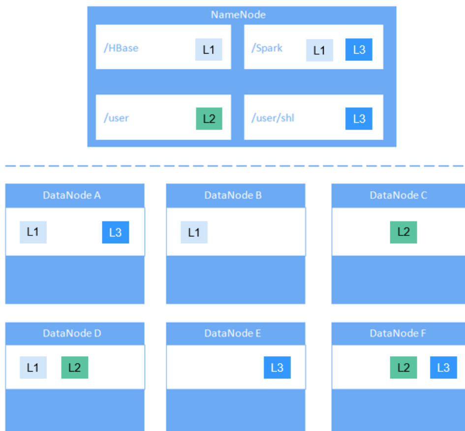
图 1-77 基于标签的数据块摆放策略样例
