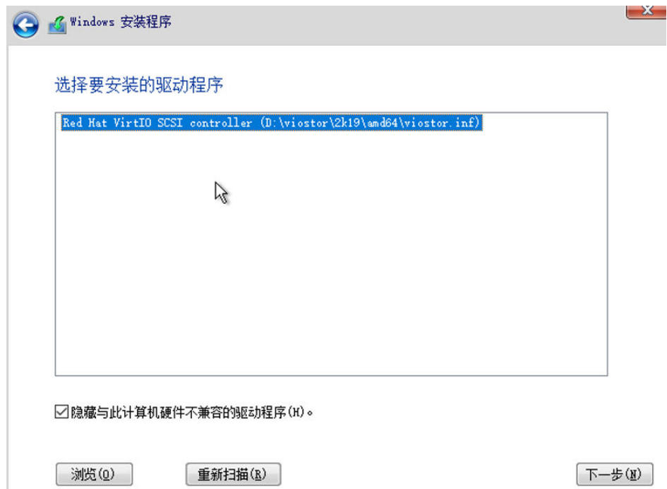
图 3-19 选择要安装的驱动程序 viostor.inf
