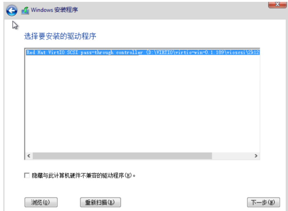
图 3-21 选择要安装的驱动程序 vioscsi.inf
