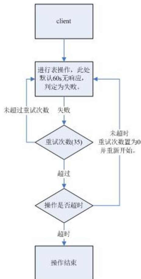
从该流程可以看出，如果未对这两个配置参数根据具体使用场景进行配置，会造成挂起迹象。建议根据使用场景，配置合适的超时时间，如果是长时间操作，则把超时时间设置长一点；如果是短时间操作，则把超时时间设置短一点。而重试次数可以设置为：“(hbase.client.retries.number)\*60\*1000(ms)”。刚好大于“hbase.client.operation.timeout”设置的超时时间。
