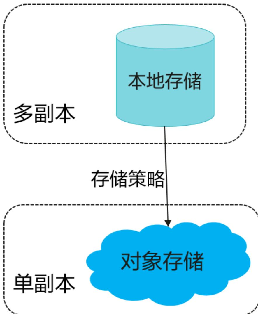
OBS对象存储支持海量数据存储，并提供安全可靠的、低成本的分布式存储服务。Doris主要基于OBS实现冷热分离功能，如[图6-5](#)所示。
