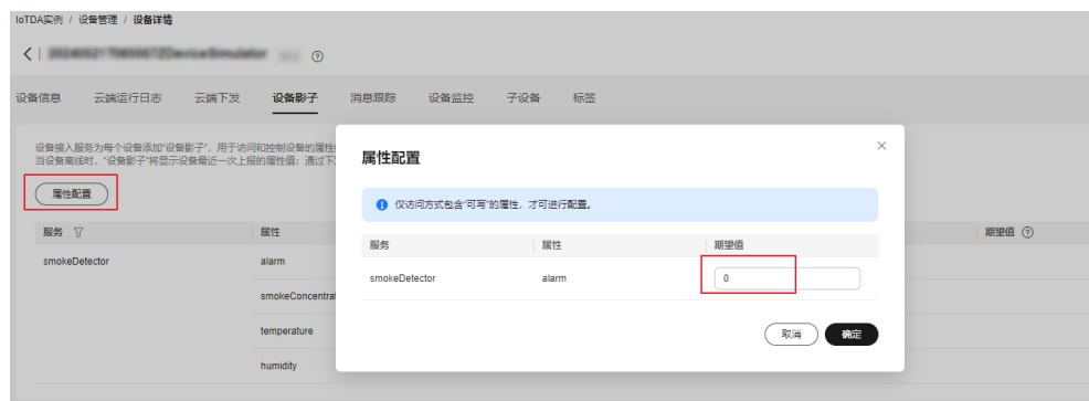
图 3-7 设备影子-属性配置 alarm
