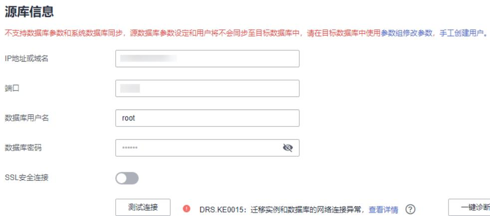
**步骤3** 等待诊断完成后，可在弹出的“诊断详情”窗口查看结果，包括丢包率和端口检查结果。
