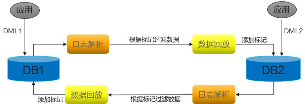
防回环同步原理概述(DML)
