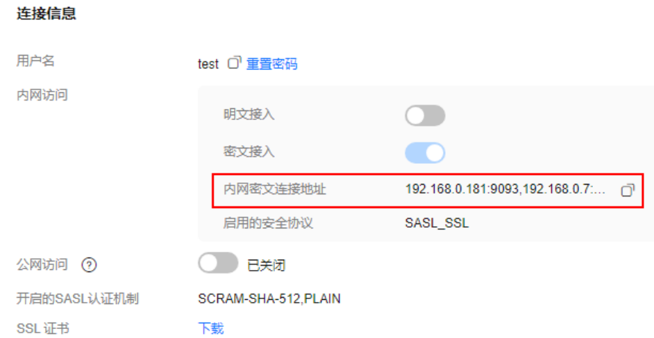
图 1-5 使用内网通过同一个 VPC 访问 Kafka 实例的连接地址
