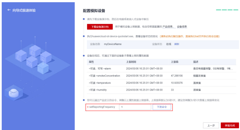
图 1-9 向导式极速体验-设备属性上报频率
