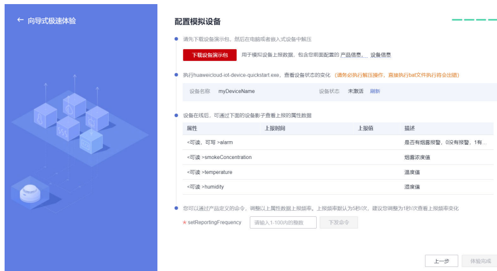
图 1-7 向导式极速体验-配置模拟设备
