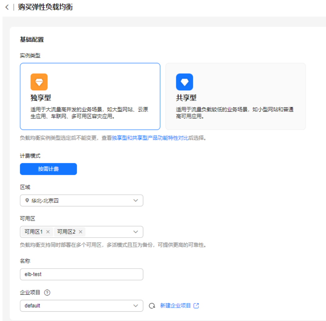
图 2-8 负载均衡器的基础配置
