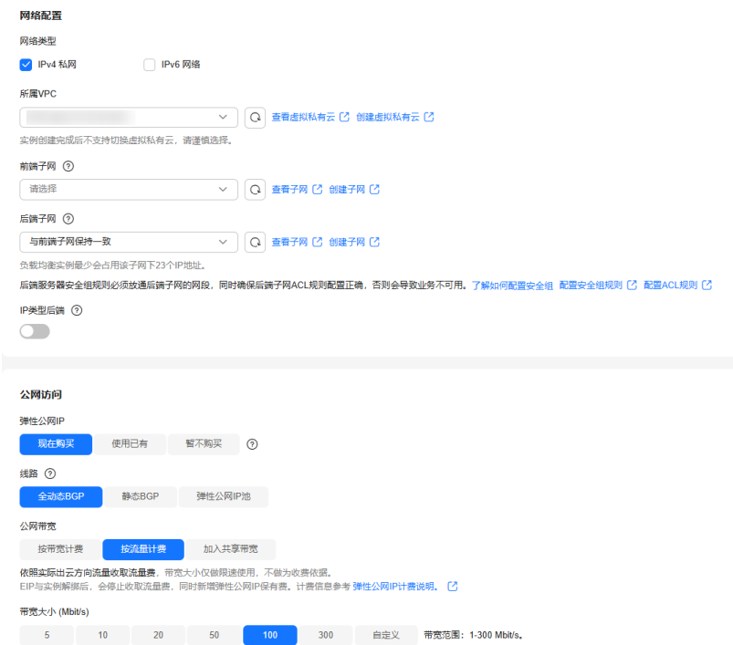
图 2-10 负载均衡器的网络配置
