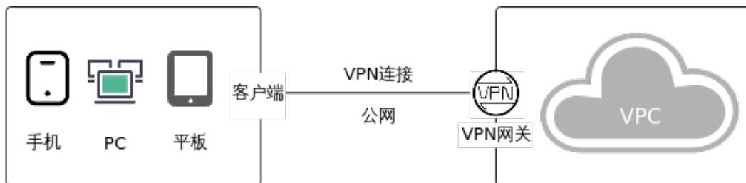
图 2-2 终端入云 VPN 组网图
