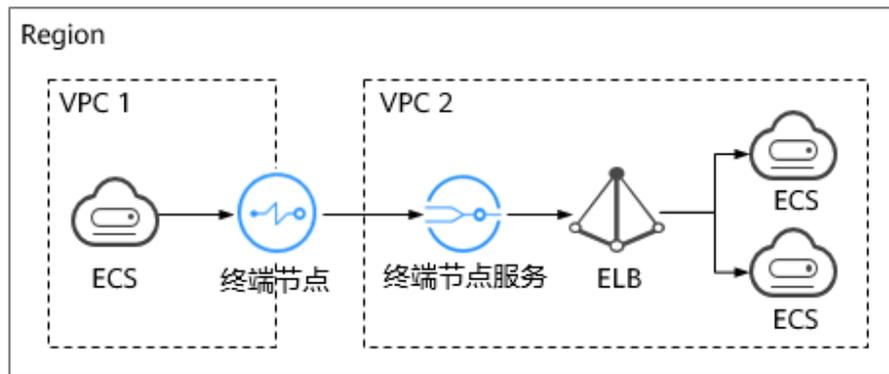
如[图3-2](#)所示，利用终端节点与终端节点服务建立的跨VPC连接通道，实现VPC 1中的云资源（如ECS）通过内网访问VPC 2中的云资源（如ELB）。
