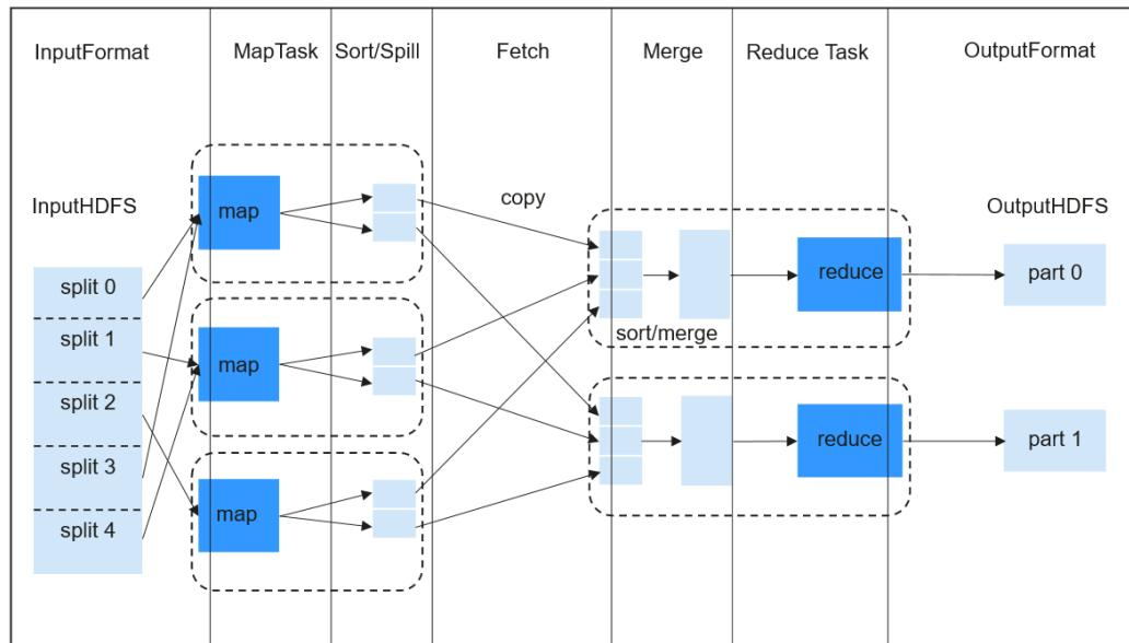
图 6-81 MapReduce 作业执行流程
