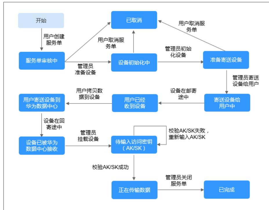
图 2-2 磁盘方式状态转换
