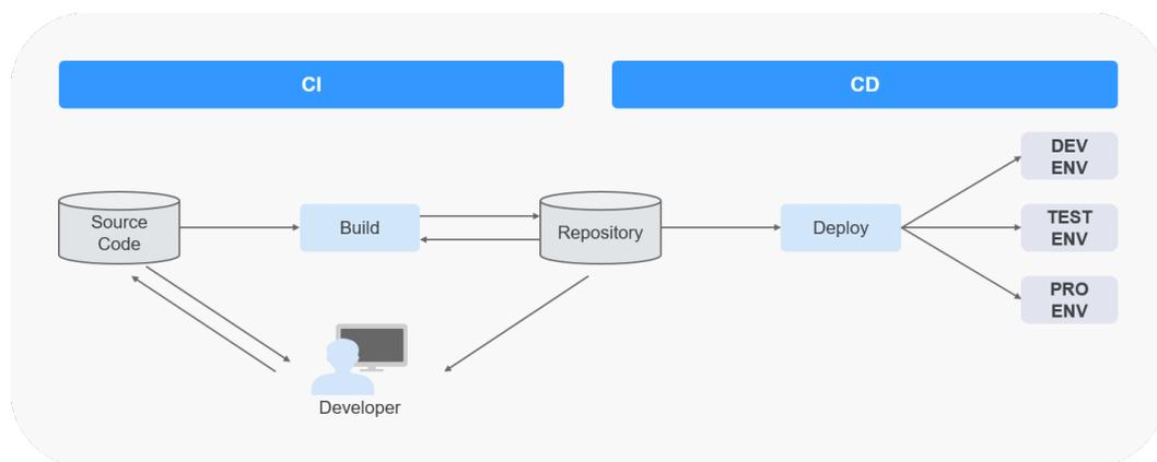
图1-1中的Repository即制品仓库，用于管理软件开发过程产生的软件包，它是连接持续集成和持续交付的重要环节，软件包的发布评审、追溯和安全控制等操作通常在其中进行。
