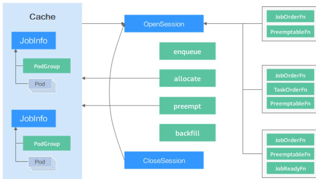
Volcano scheduler通过插件方式提供了多种调度Action（例如enqueue，allocate，preempt，backfill）以及调度策略（例如gang，priority，drf，proportion，binpack等），用户可以根据实际业务需求进行配置。通过实现Scheduler提供的接口也可以方便灵活地进行定制化开发。
