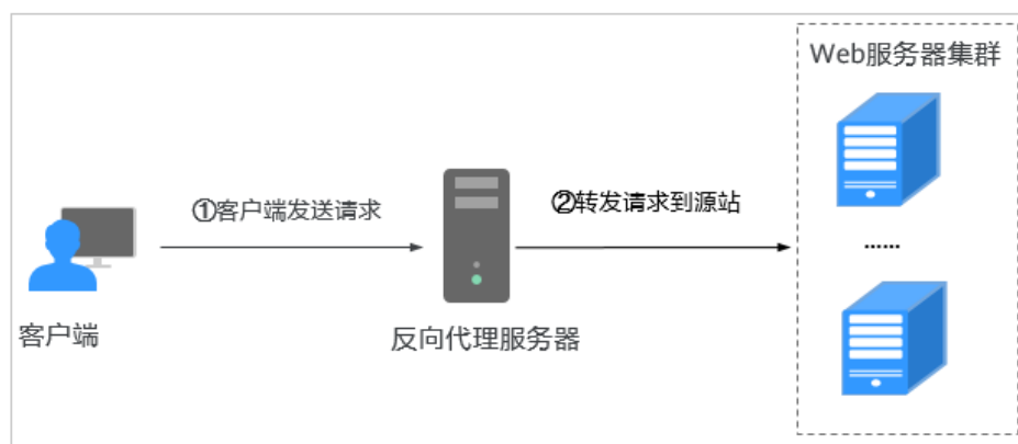
图 12-3 Nginx 转发原理
