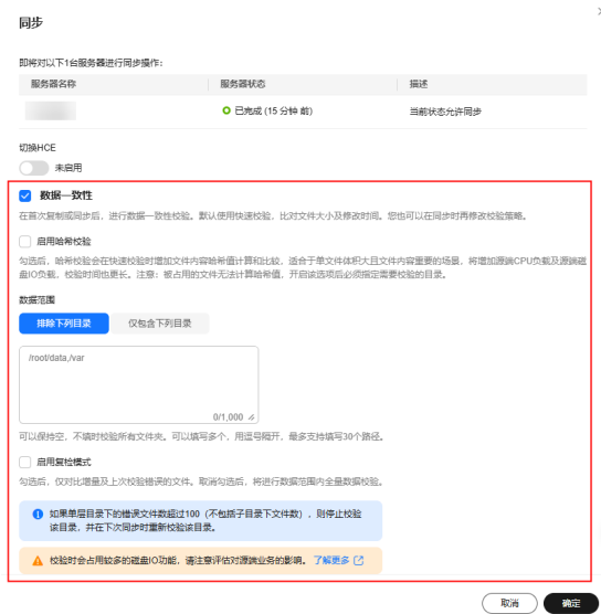
图 4-1 增量同步时启用数据一致性校验
