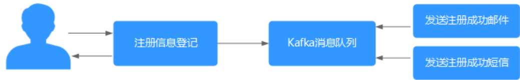
图 1-2 借助消息队列异步发送注册邮件与短信流程
