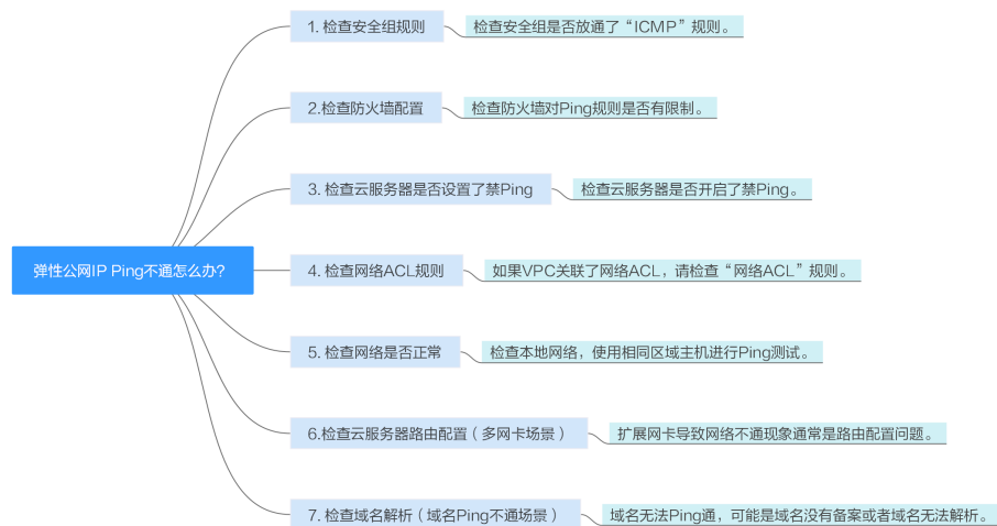
图 15-148 弹性公网 IP Ping 不通排查思路
