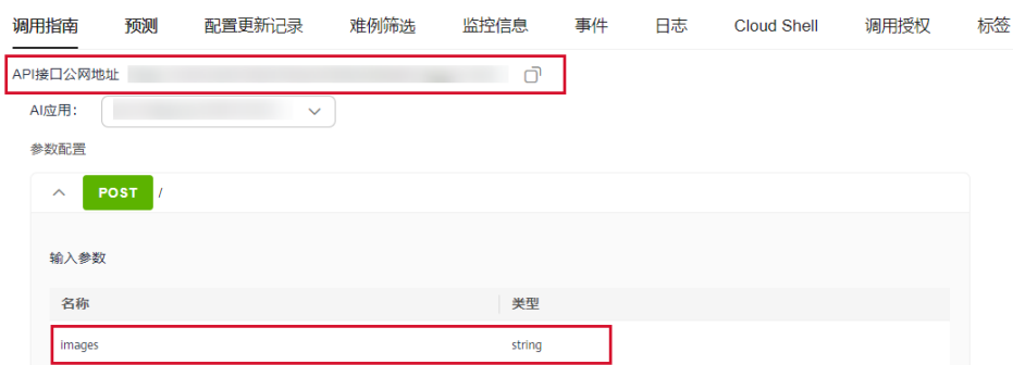
图 3-18 获取在线服务 API 接口地址和文本预测输入参数信息
