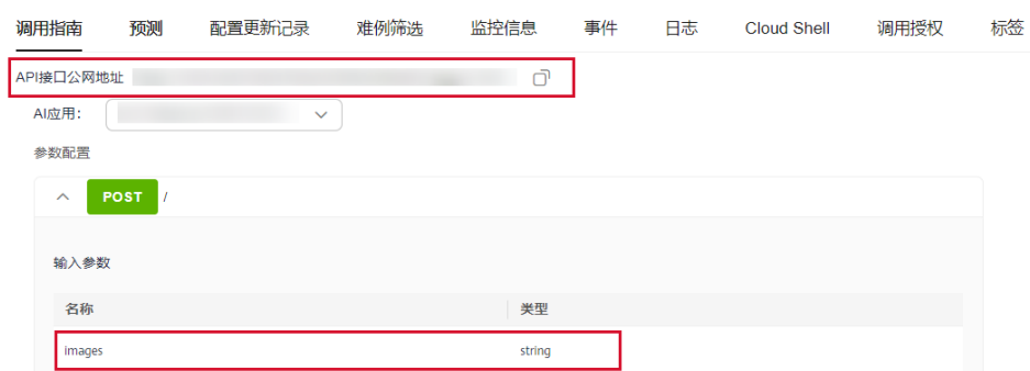
图 3-9 获取在线服务 API 接口地址和文本预测输入参数信息
