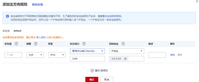
图 2-10 添加出方向规则（读写内网地址）
