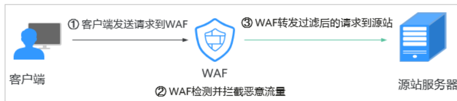
图 8-2 CNAME 接入、独享模式接入防护原理
