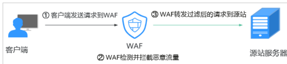
图 1-1 CNAME 接入、独享模式接入防护原理
