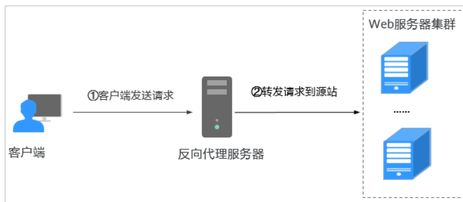
图 8-3 Nginx 转发原理
