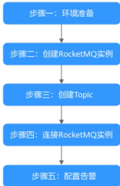
图 2-1 RocketMQ 使用流程
