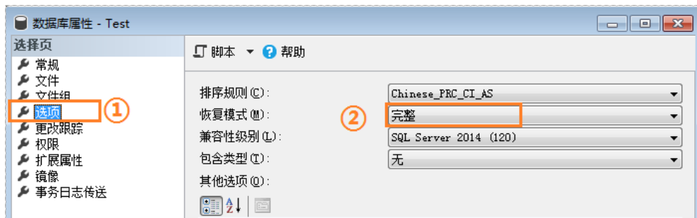
图 5-13 检查数据库恢复模式
