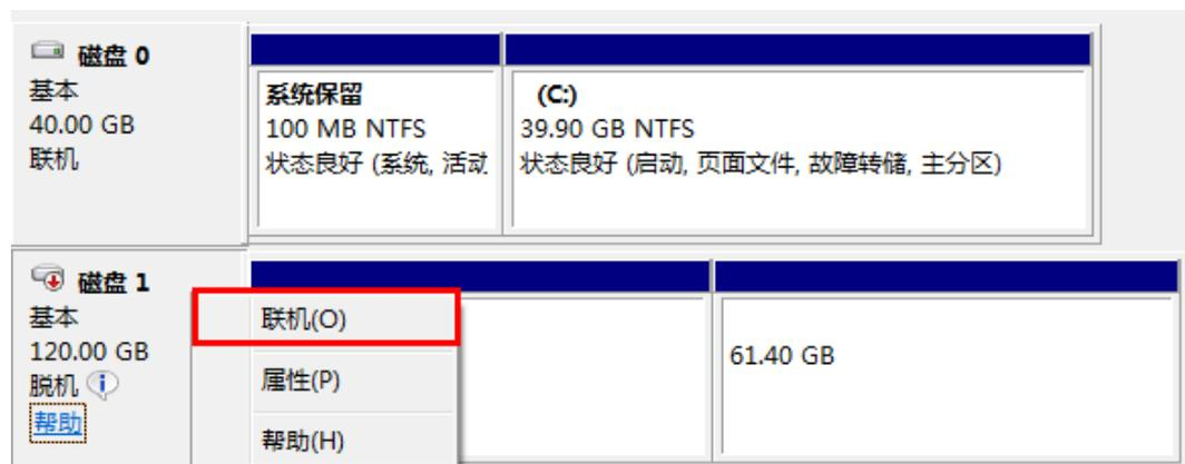
数据盘置为联机状态后，会在上方的磁盘列表中显示，如图5-3所示。
