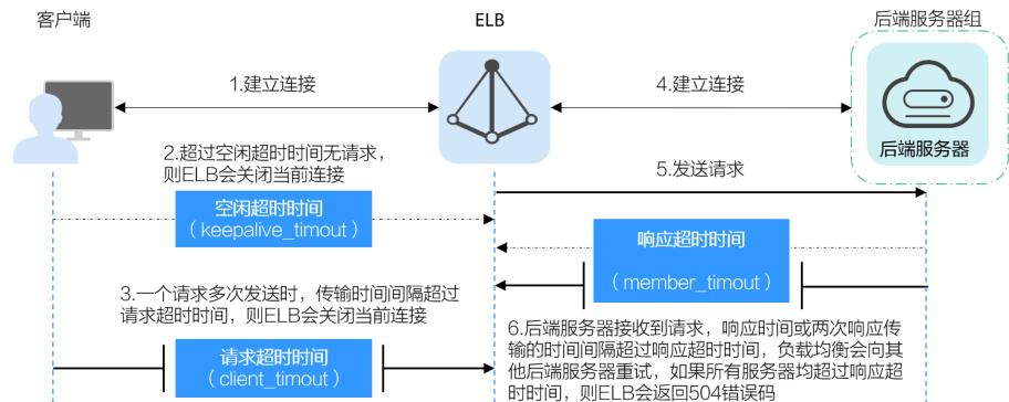
图 6-2 四层监听器超时时间示意图
