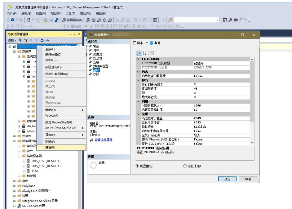
登录本云实例控制台，在实例管理页，单击目标实例名称，进入基本信息页签，切换至“参数修改”，搜索最大并行度（max degree of parallelism）并进行修改。
