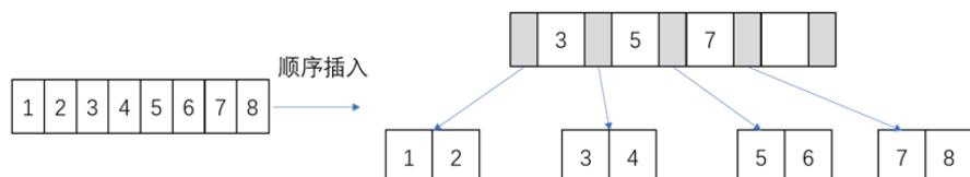
当并行后有非顺序插入数据时，如[图1-17](#)，当最后数据4插入时，会导致数据3、5叶子节点分裂，分裂后的叶子节点存在磁盘空余空间。
