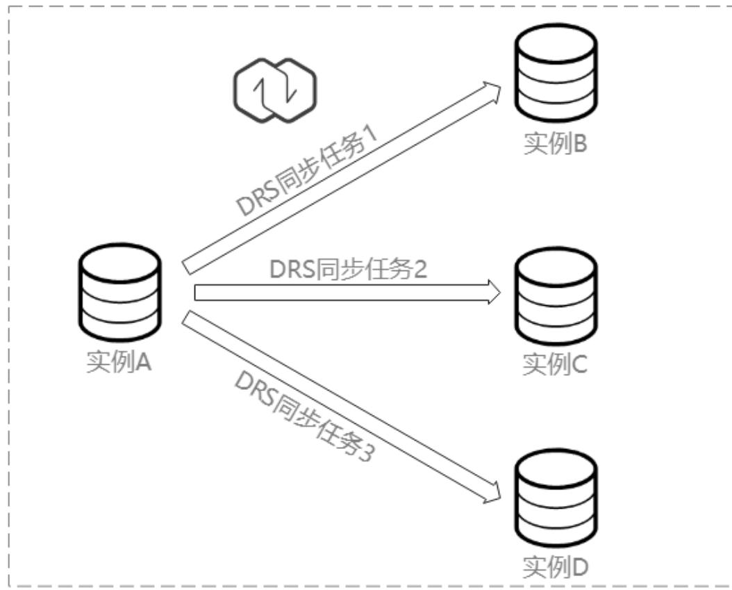
用户需要创建多个同步任务来实现一对多的实时同步。例如从实例A同步到实例B、实例C和实例D，需要创建三个同步任务。
