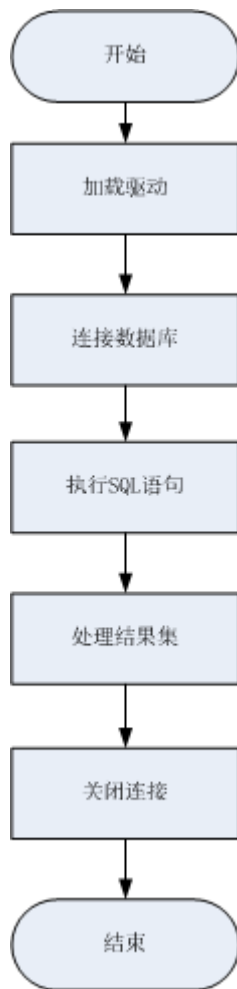
图 5-4 采用 Psycopg2 开发应用程序的流程
