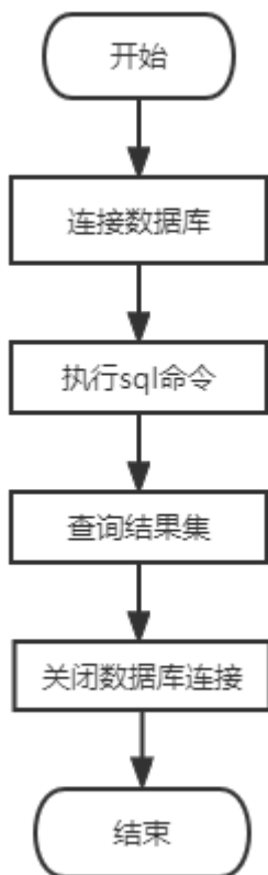
图 5-6 嵌入式 SQL-C 程序开发流程
