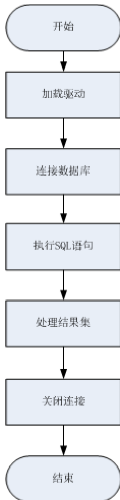
图 6-1 采用 JDBC 开发应用程序的流程
