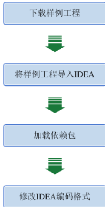
图 9-4 导入样例工程流程
