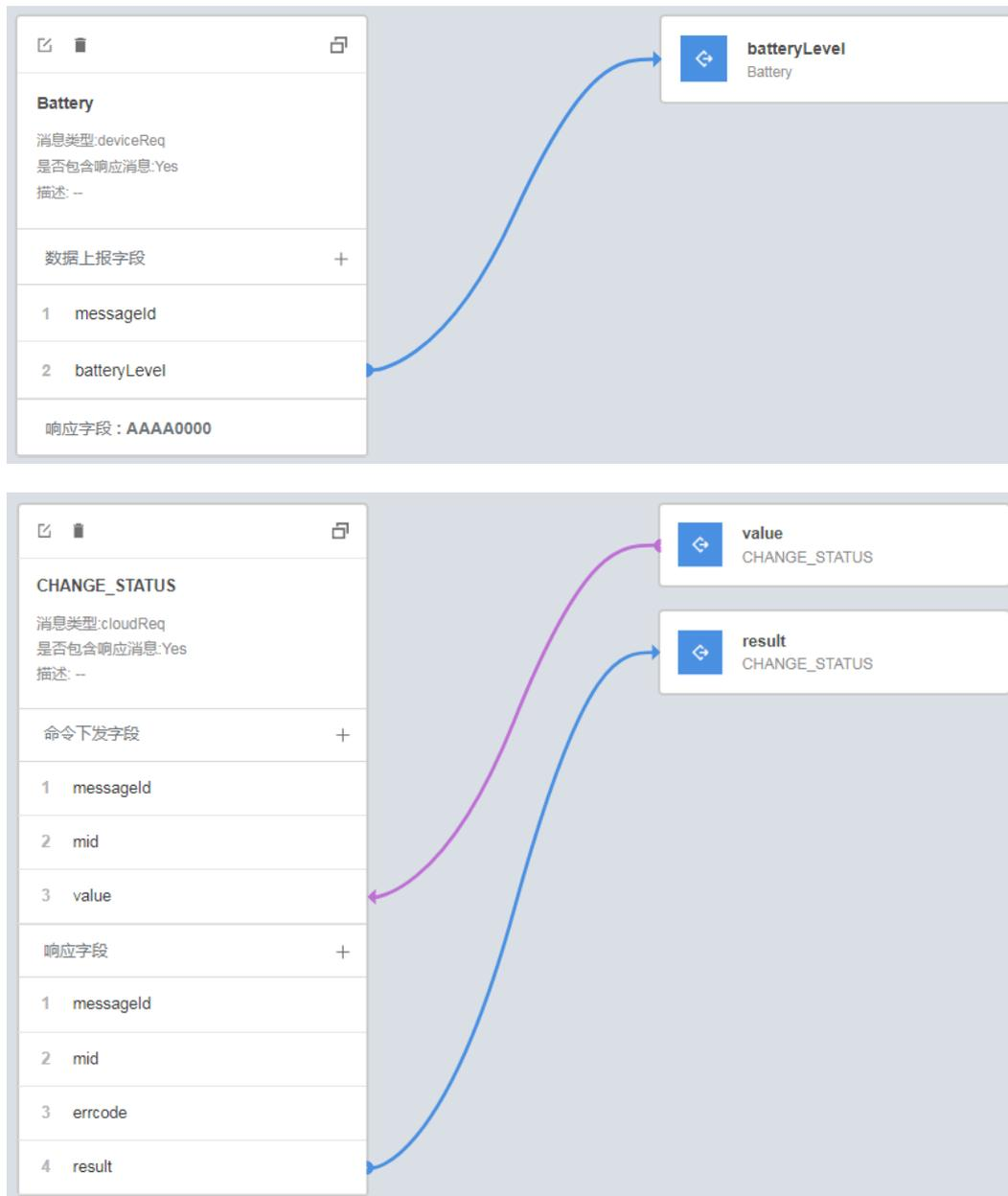
**步骤25** 点击“保存”，并在插件保存成功后点击“部署”，将编解码插件部署到物联网平台。
