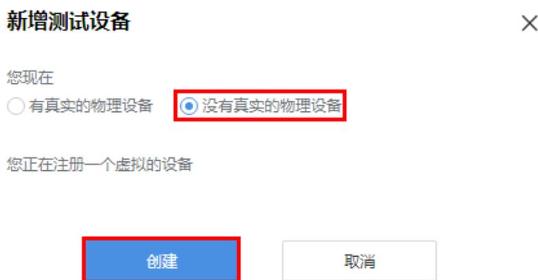
**步骤4** 在设备列表中，选择新创建的虚拟设备，进入调试界面。虚拟设备名称组成为：“产品名称”+“Simulator”，每款产品下只能够创建一个虚拟设备。
