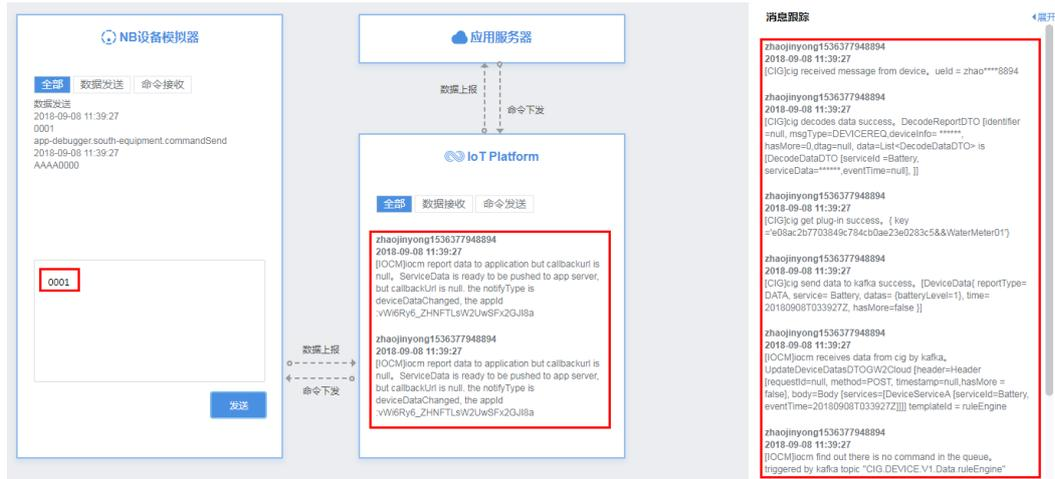
**步骤4** 在eclipse中“TestSubscribeAllNotification.java”的控制台查看物联网平台推送给应用服务器的消息。
