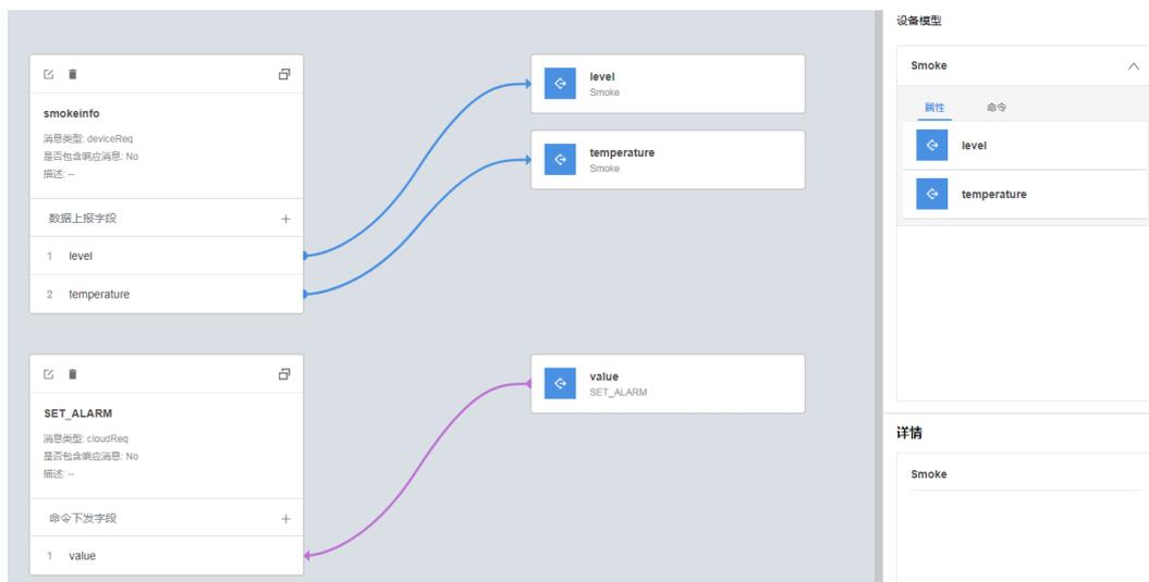
**步骤5** 点击“保存”，并在插件保存成功后点击“部署”，将编解码插件部署到物联网平台。
