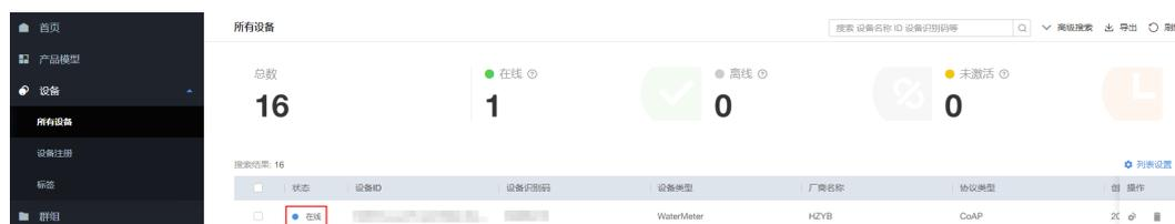
**步骤5** 点击对应的设备，进入设备详情页，在详情页中查看“最近上报数据”，如果能正常解析和显示对应的数据，则表示设备上报数据成功。
