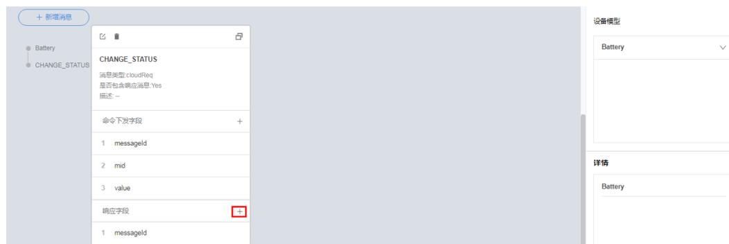
**步骤19** 系统将弹出“增加字段”窗口，勾选“标记为响应标识字段”，其余参数将自动填充，点击“完成”。
