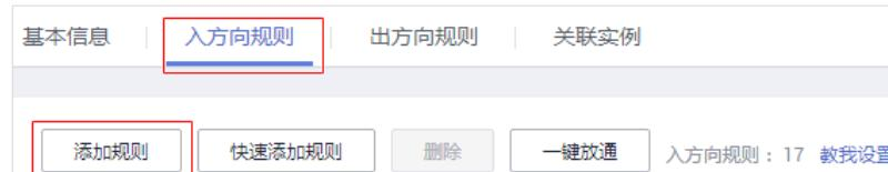
2. 在“添加入方向规则”对话框中，为**步骤1**中安装节点IP添加TCP协议（端口为8000）和UDP协议（端口为7000-7100）规则，如**图4-23**所示。
