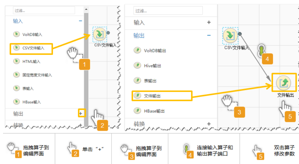
图 17-30 算子操作方法示意
