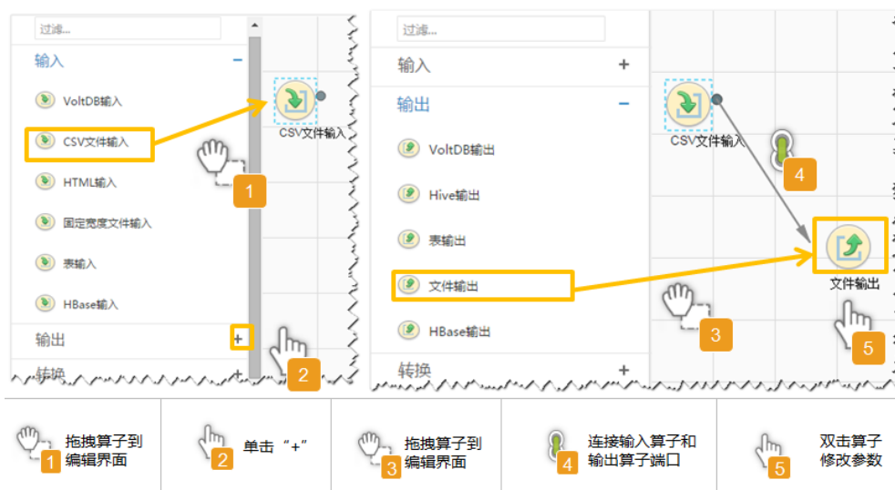
图 17-62 算子操作方法示意
