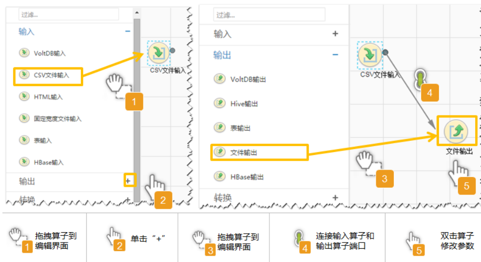
图 17-66 算子操作方法示意
