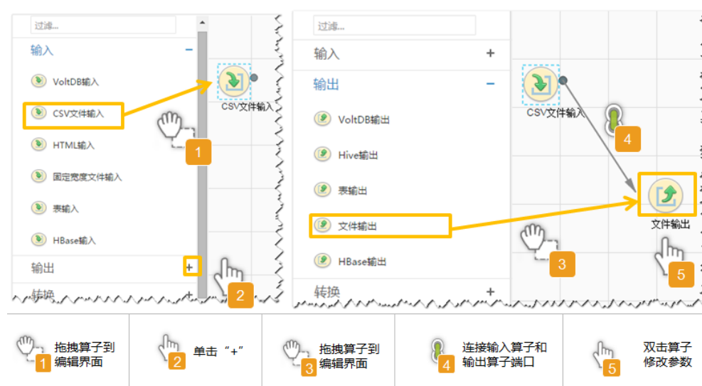
图 17-50 算子操作方法示意
