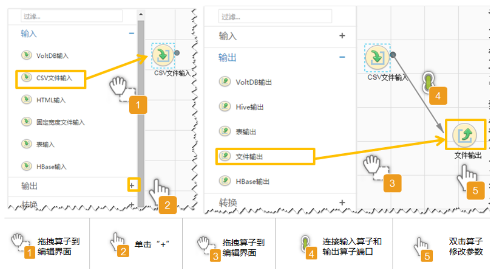
图 17-14 算子操作方法示意
