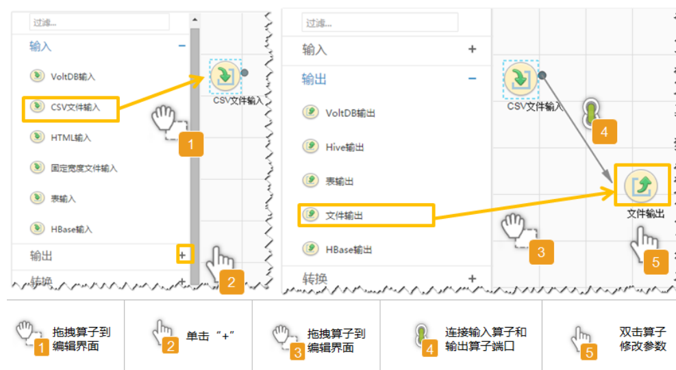
图 17-58 算子操作方法示意
