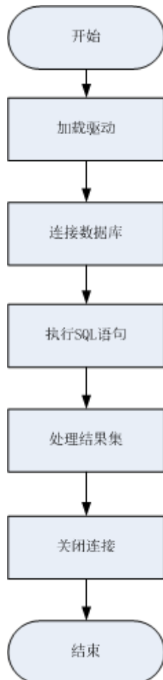
图 5-1 采用 JDBC 开发应用程序的流程
