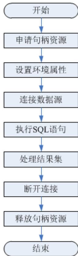
图 5-3 ODBC 开发应用程序的流程
