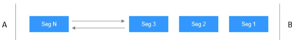
上图中用户A通过13个100字节的段发送1k字节的数据，每个段具有20字节的TCP头，总计是13个段。在接收端，用户B接收了段1,2,4,6,8-13，而段3,5和7丢失，B没有收到到。
