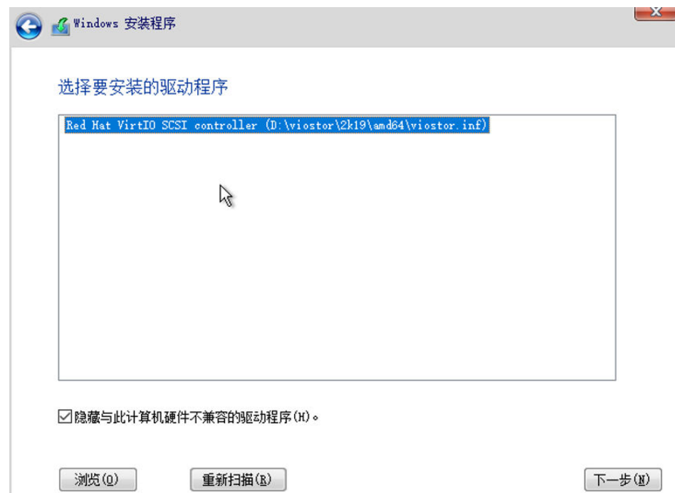
图 4-11 选择要安装的驱动程序 viostor.inf
