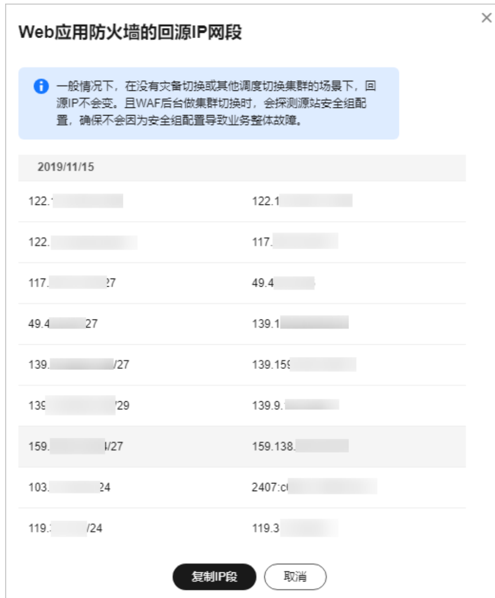
图 5-8 Web 应用防火墙的回源 IP 网段
